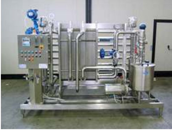
चित्र-2 : दुग्ध पास्चराइजेशन हेतु प्लांट में लगा प्लेट हीट एक्सचेंजर (पी.एच.ई.)
